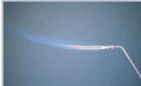
Eine zu starke Flammeneinstellung provoziert eine Legierungsüberhitzung – die Folge sind lunkrige, poröse Güsse mit zerstörtem Gefüge und evtl. unkontrollierter Veränderung der Legierungszusammensetzung.
